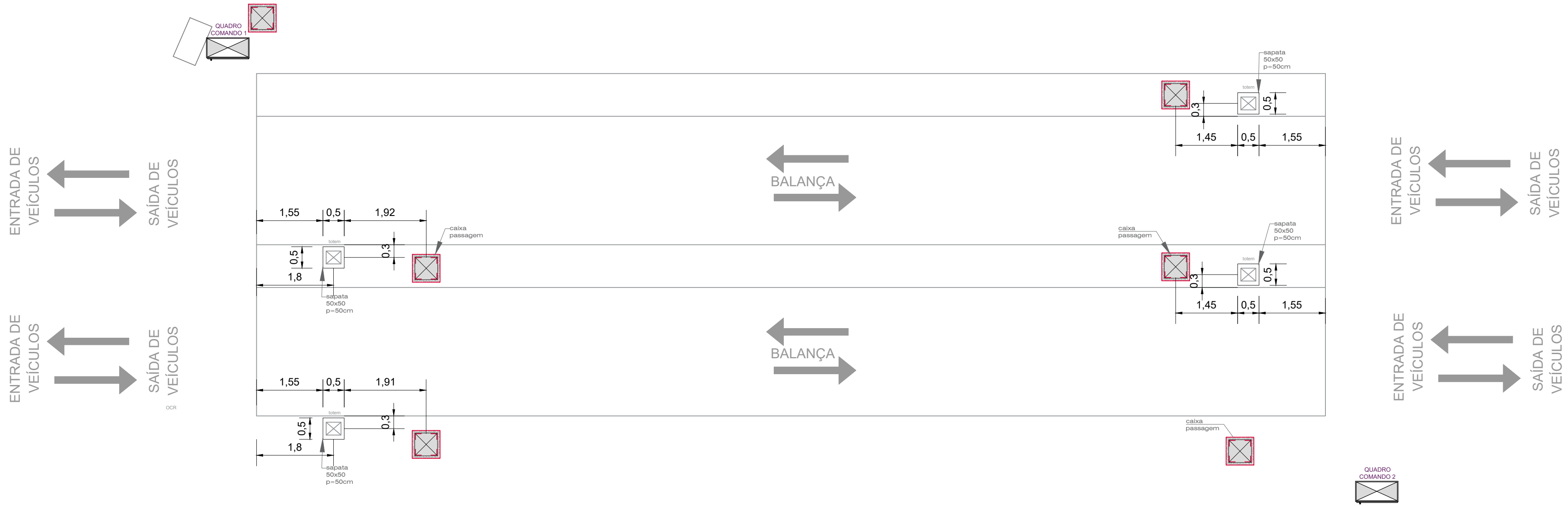
PLANTA BAIXA BALANÇA COM O POSICIONAMENTO DA INFRAESTRUTURA PARA ATENDER OS PORTAIS OCR Escala 1:75
