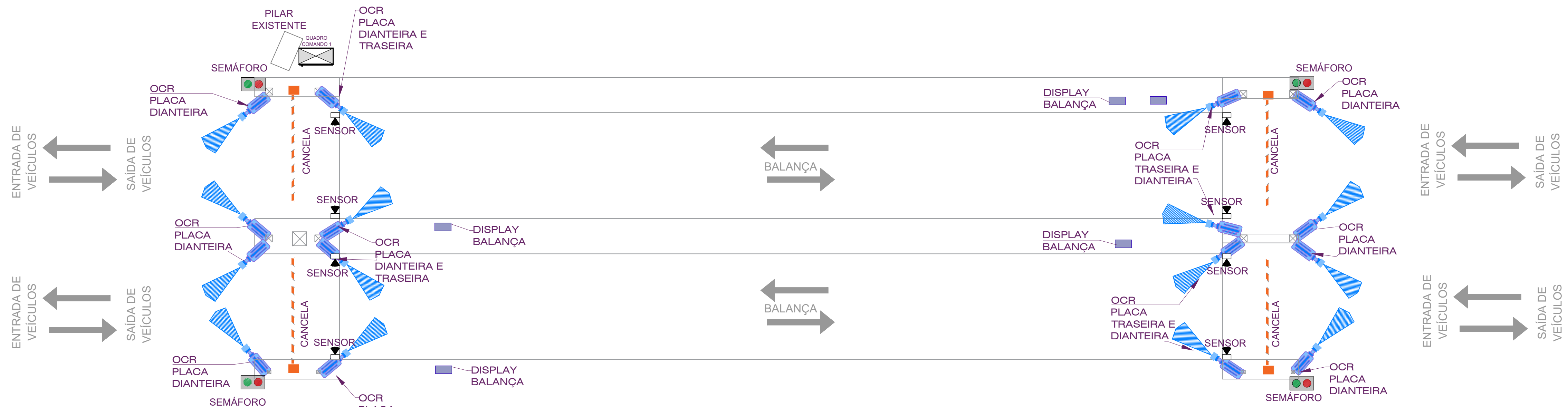
PLANTA BAIXA BALANÇA COM O POSICIONAMENTO DOS EQUIPAMENTOS DE OCR Escala 1:75
