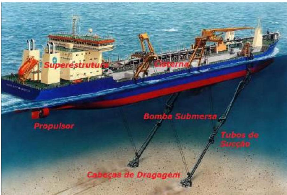
Figura 61. Ilustração esquemática de uma draga de sucção por arrasto do tipo autotransportadora (TSHD), com representação das partes mais relevantes à dragagem.
