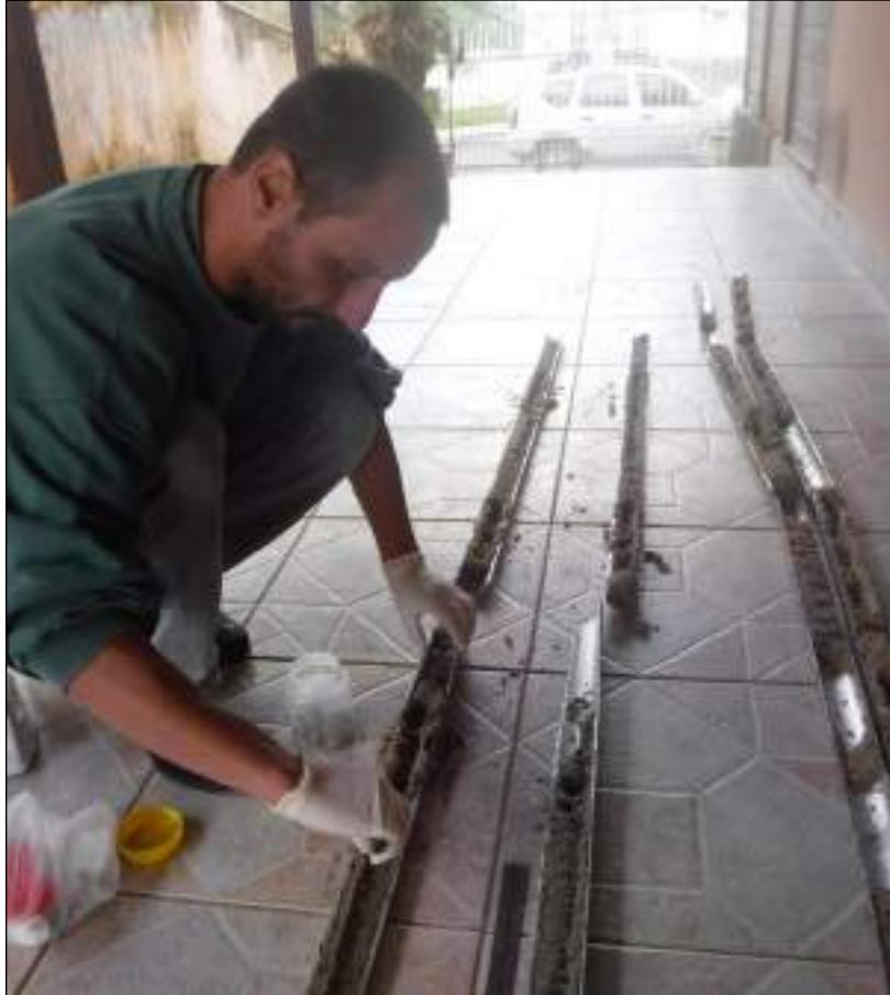
Figura 42. Procedimento de registro das fácies sedimentares e retirada das amostras para envio ao laboratório de análises.
