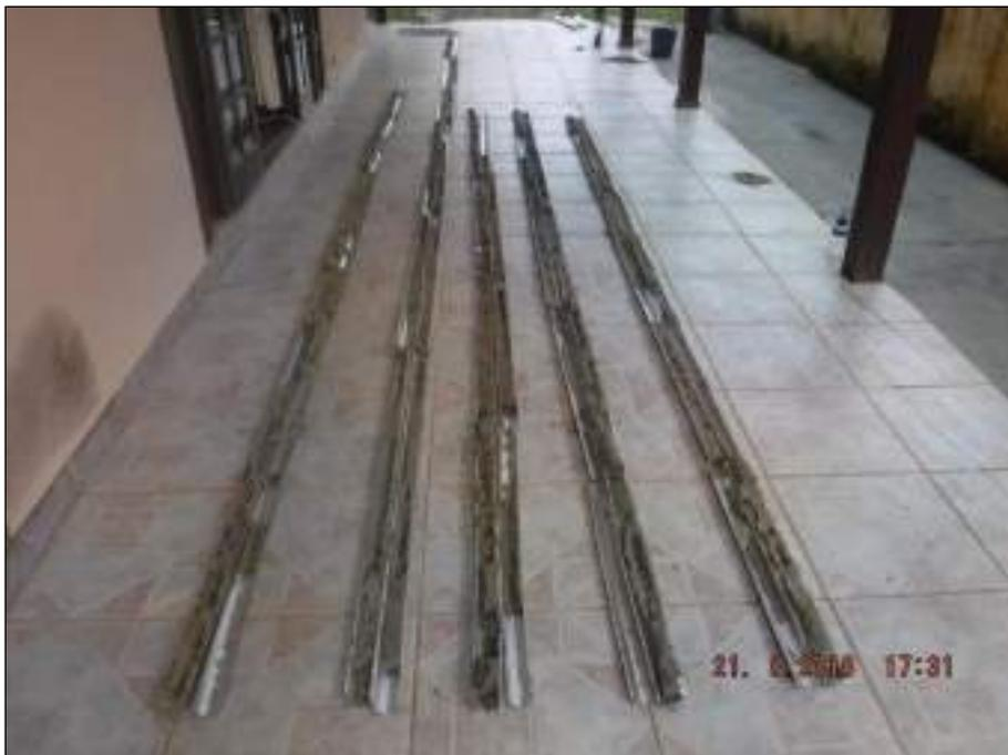
Figura 41. Testemunhos abertos para retirada das amostras e registro da seqüência vertical de fácies.
