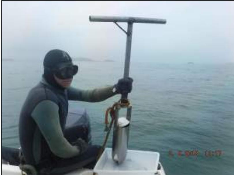
Figura 34. Mergulhador munido do amostrador do tipo *Trado Caneco* na região do sistema aquaviário.
