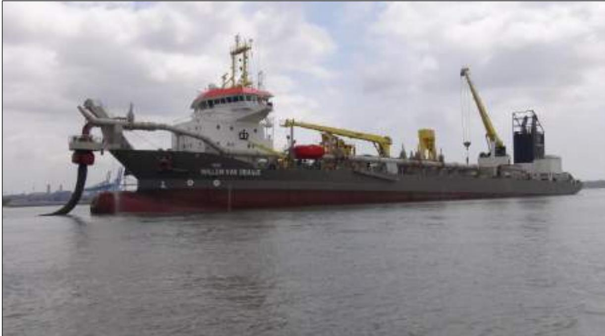
Figura 67. Registro fotográfico de draga de sucção e arrasto autotransportadora com linha de recalque conectada a seu sistema de lançamento de proa.
