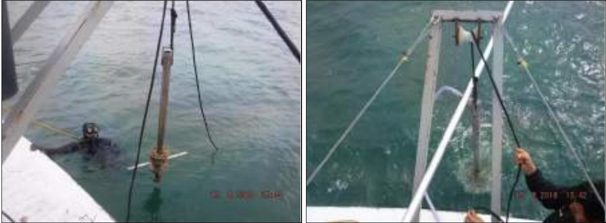
Figura 38. Procedimento de descida e içamento do tubo de alumínio pelo guincho no sistema de Vibracore.
