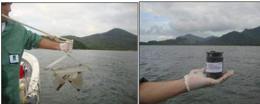
Figura 30. Amostrador tipo *van Veen* utilizado para a coleta de amostras de sedimento e acondicionamento do sedimento em frascos plásticos devidamente identificados.
