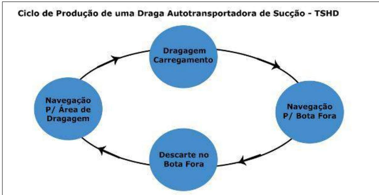
Figura 62. Ciclo de produção de uma draga autotransportadora de sucção - TSHD.
