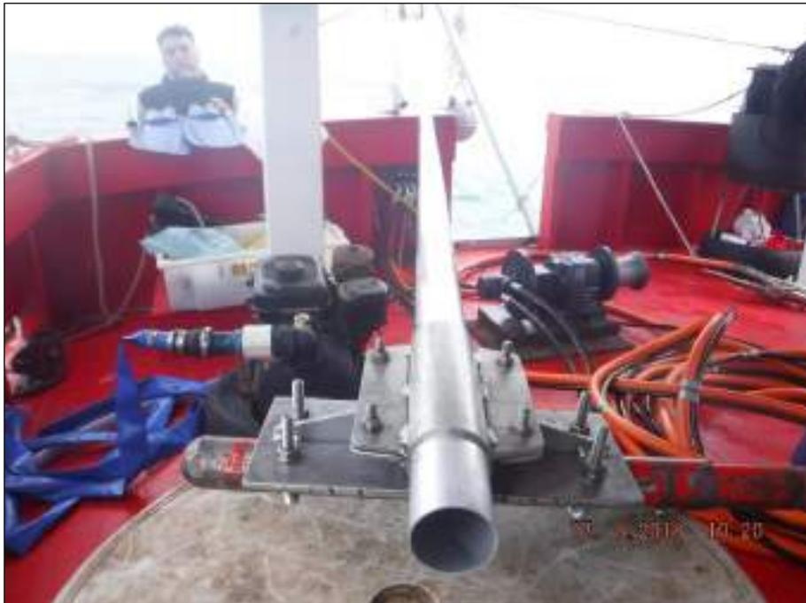
Figura 36. Conjunto de equipamentos que compõem o sistema *Vibracore* a bordo da embarcação.
