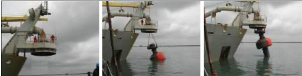
Figura 68. Registro fotográfico das etapas de conexão da linha de recalque ao sistema de descarte de sedimento por lançamento de uma draga de sucção e arrasto autotransportadora.
