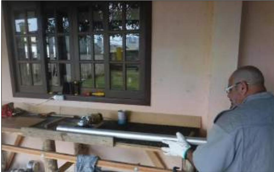
Figura 40. Procedimento de abertura dos testemunhos de sedimento em bancada.
