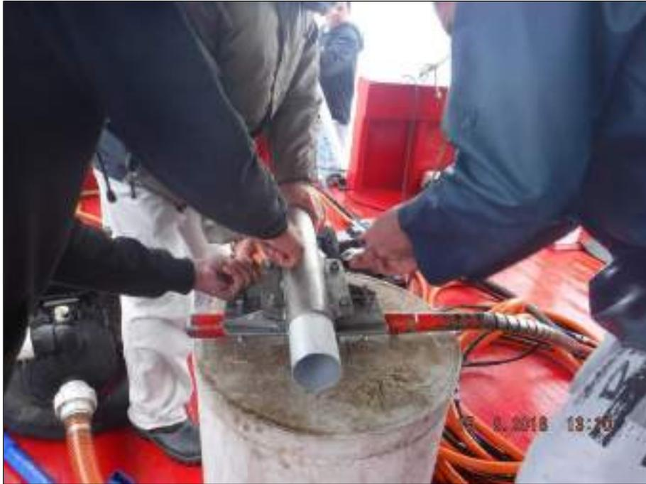
Figura 35. Ajustes no sistema de *Vibracore* previamente ao início das operações.
