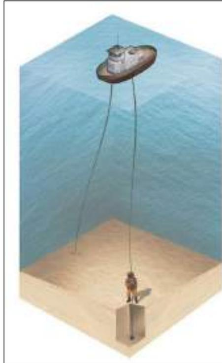
Figura 32. Ilustração da operação técnica da coleta com *Trado Caneco* operado por mergulhador profissional na amostragem dos sedimentos em subsuperfície.
