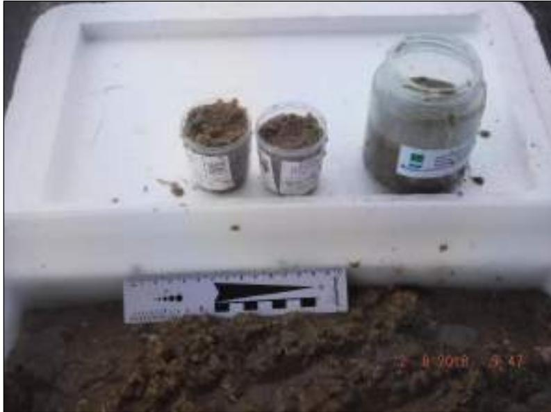
Figura 31. Acondicionamento das amostras coletadas com *van Veen* e Trado Caneco e armazenamento em caixa térmica.
