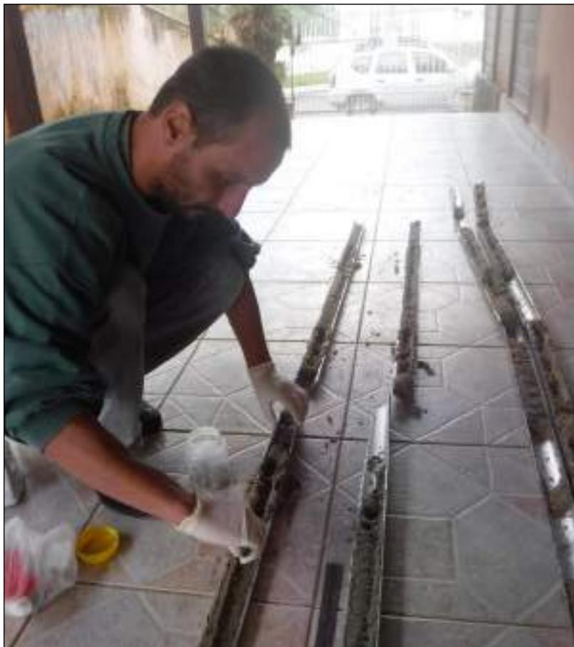
Figura 84. Procedimento de registro das fácies sedimentares e retirada das amostras para envio ao laboratório de análises.
