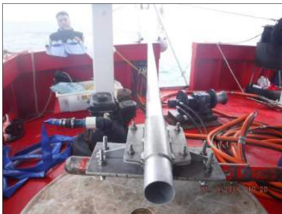
Figura 78. Conjunto de equipamentos que compõem o sistema Vibracore a bordo da embarcação.
