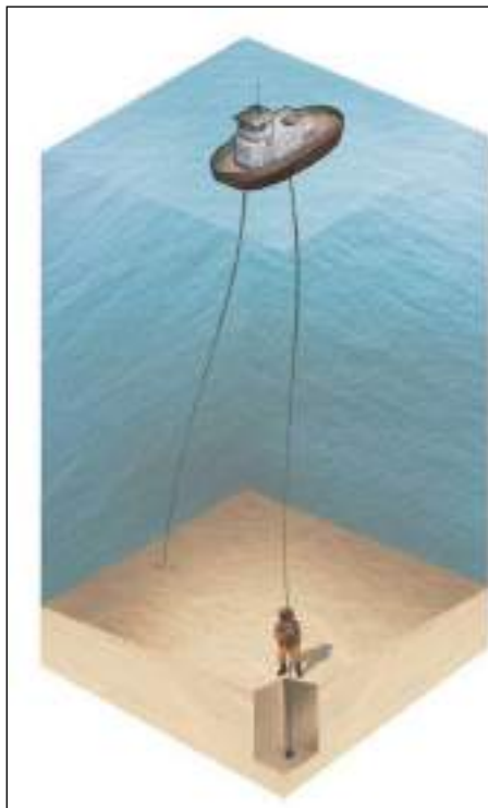
Figura 74. Ilustração da operação técnica da coleta com Trado Caneco operado por mergulhador profissional na amostragem dos sedimentos em subsuperfície.
