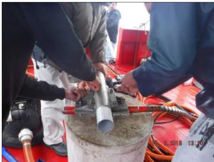
Figura 77. Ajustes no sistema de Vibracore previamente ao início das operações.
