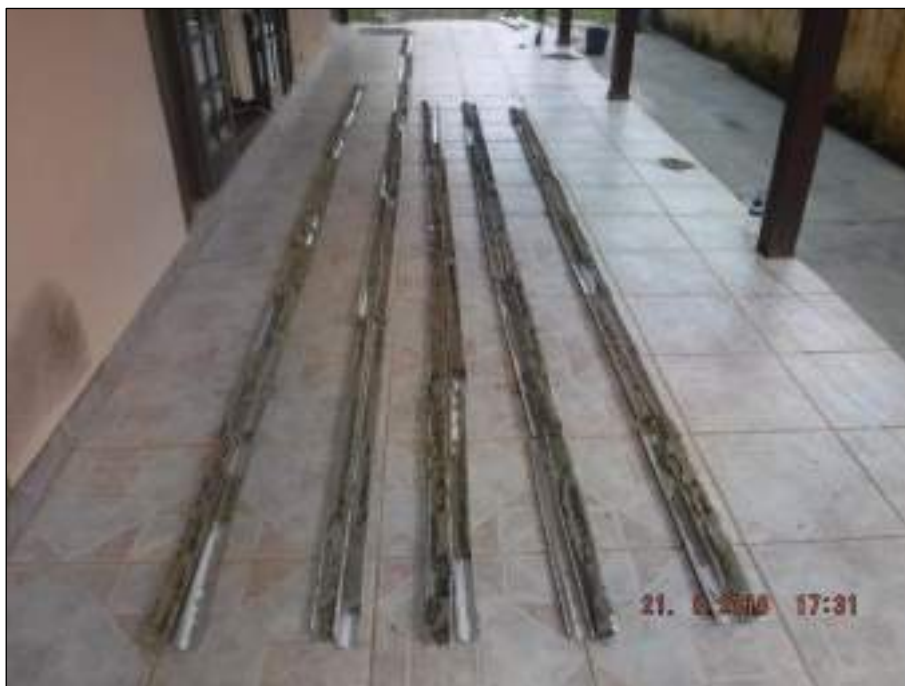
Figura 83. Testemunho aberto para retirada das amostras e registro da sequência vertical de fácies.
