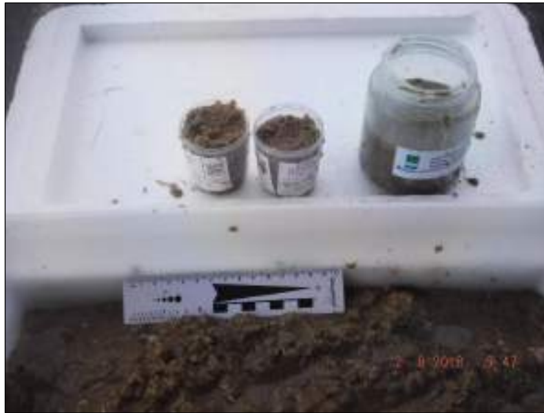
Figura 73. Acondicionamento das amostras coletadas com van Veen e Trado Caneco e armazenamento em caixa térmica.
