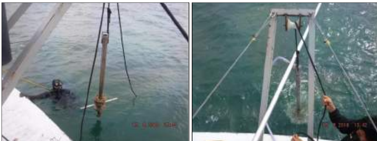
Figura 80. Procedimento de descida e içamento do tubo de alumínio pelo guincho no sistema de Vibracore .
