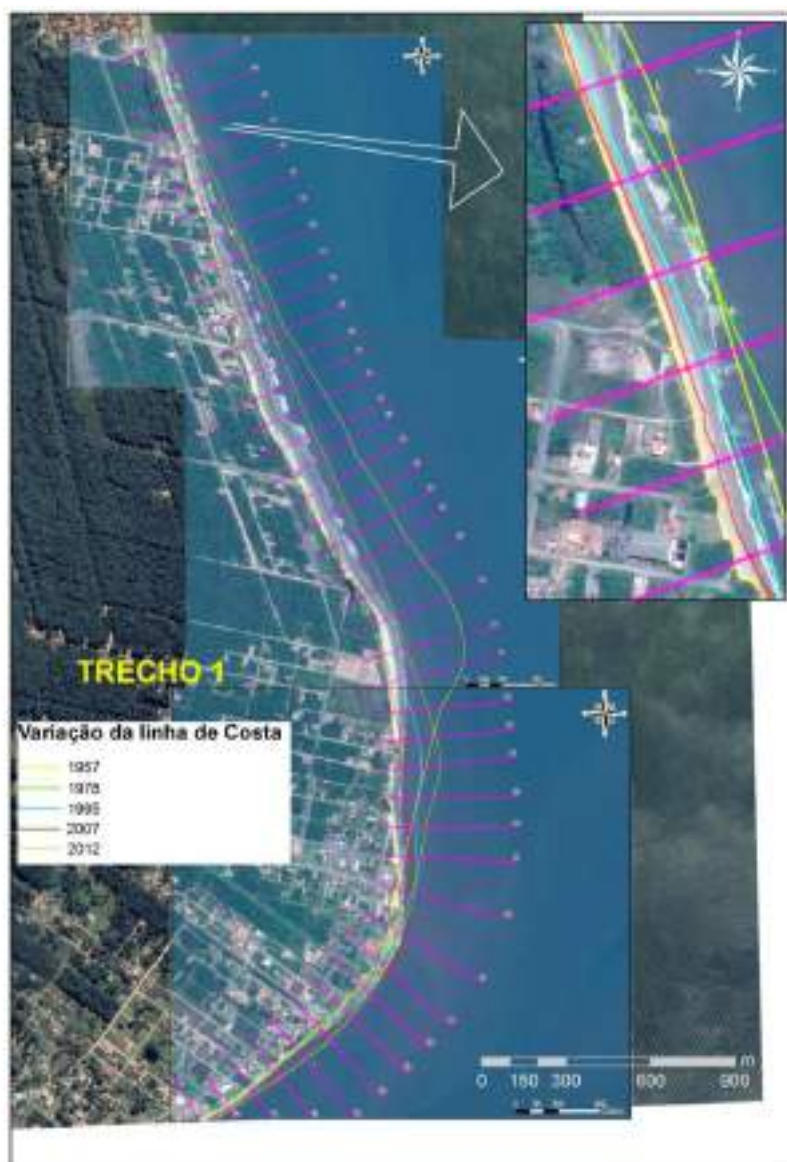
Figura 51. Exemplo de mobilidade da linha de costa entre os anos de 1957 e 2012 (transectos 36 a 71). Esta área equivale ao trecho 1 do projeto de uso benéfico dos sedimentos da dragagem de readequação e aprofundamento do canal de acesso externo ao complexo portuário de São Francisco do Sul (ACQUAPLAN, 2013, 2018).
