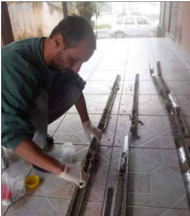
Figura 84. Procedimento de registro das fácies sedimentares e retirada das amostras para envio ao laboratório de análises.
