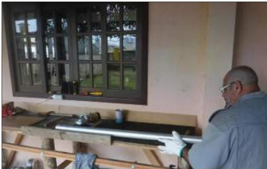
Figura 82. Procedimento de abertura dos testemunhos de sedimento em bancada.
