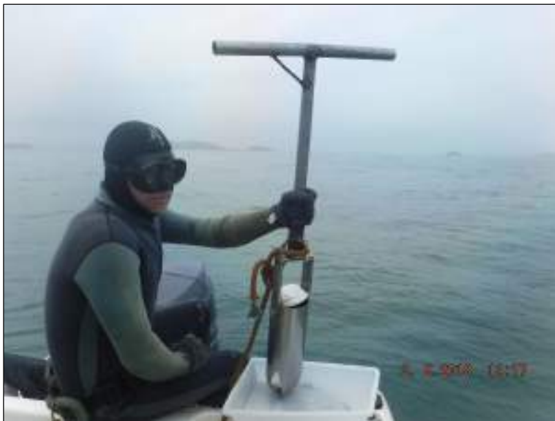
Figura 76. Mergulhador munido do amostrador do tipo Trado Caneco na região do sistema aquaviário.
