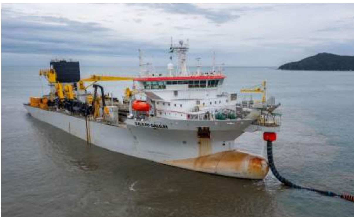
Figura 106. Draga autotransportadora de sucção e arrasto (hopper) fazendo o bombeamento do sedimento para a praia.
