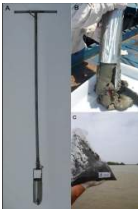
Figura 75. Amostrador do tipo Trado Caneco : (A) sedimento coletado sendo extraído do amostrador; (B) amostra sendo acondicionada em embalagem plástica (C).
