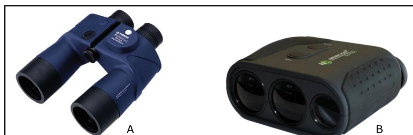
Figura 48. Binóculos reticulado 7X50 (A), e Rangefinder a laser (B), utilizados em campo para o monitoramento de cetáceos.
