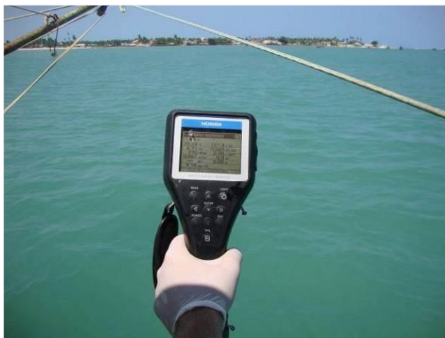
Figura 28. Sonda multiparâmetros para aquisição de dados na área de estudo do sistema aquaviário do complexo portuário de São Francisco do Sul (SC).
