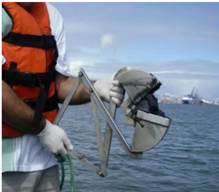
Figura 59. Amostrador de sedimento do tipo van Veen .
