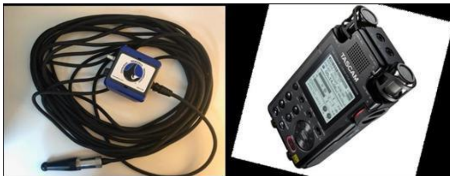
Figura 22. À esquerda o Hidrofone Cetacean Research Model C75-DR100, e à direita o gravador digital TASCAM DR-100 mkIII, utilizados para a coleta de dados de acústica.
