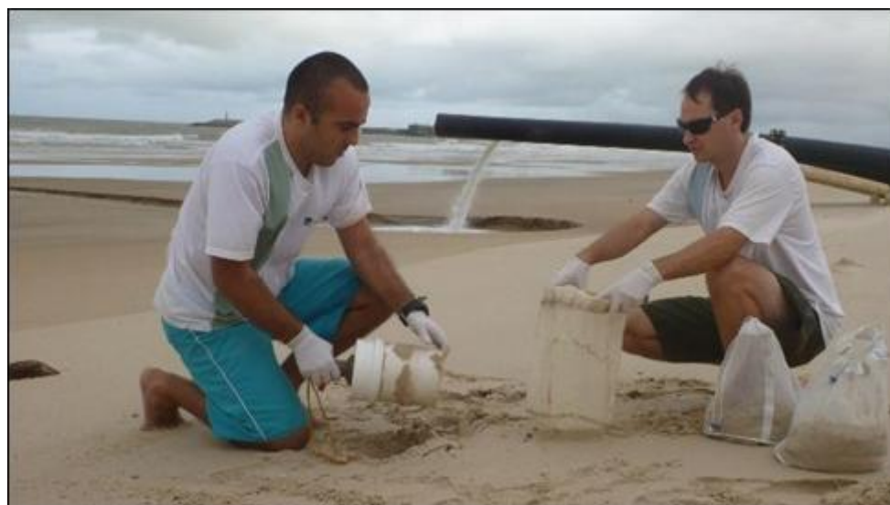
Figura 38. Amostrador utilizado para coleta da macrofauna bentônica de praia arenosa.
