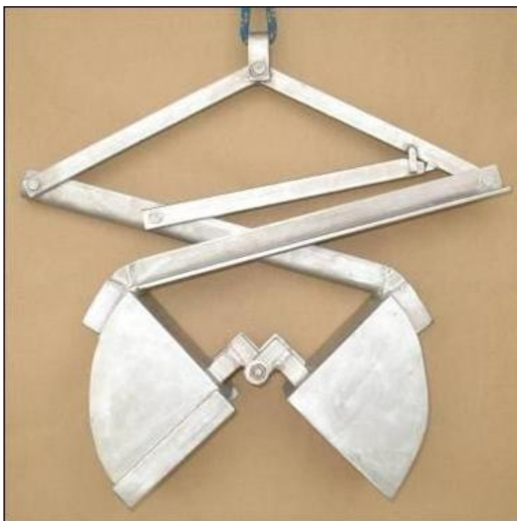
Figura 6. Amostrador do tipo van Veen utilizado para coleta de sedimentos superficiais.
