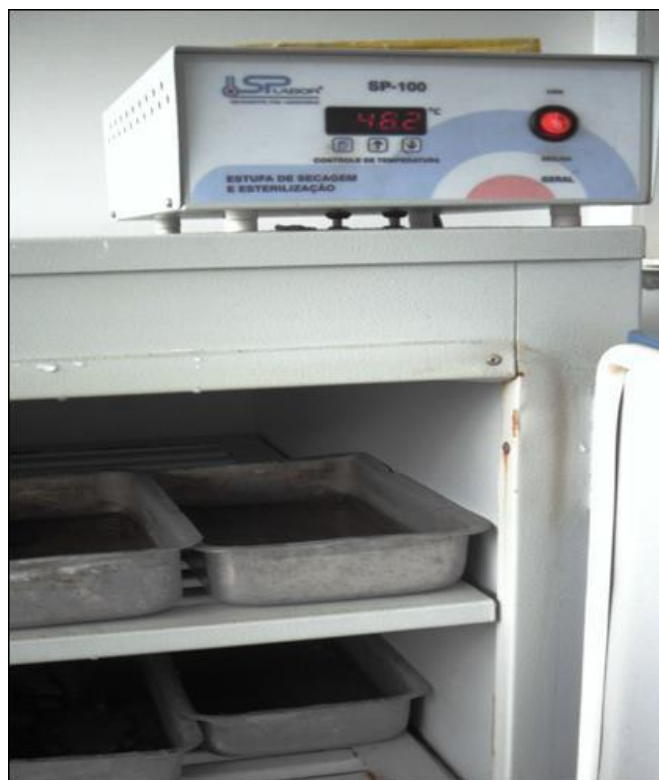
Figura 17. Estufa utilizada para a secagem dos sedimentos.
