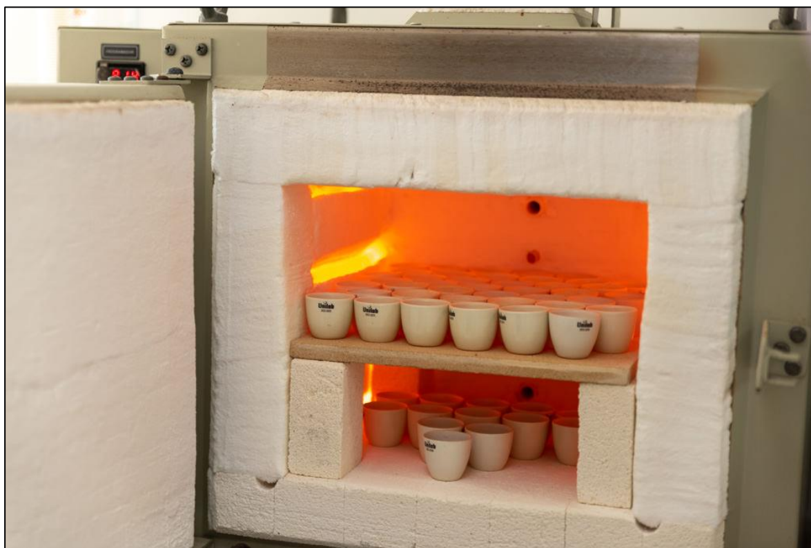
Figura 19. Forno mufla, utilizado para a determinação de matéria orgânica e carbonatos.
