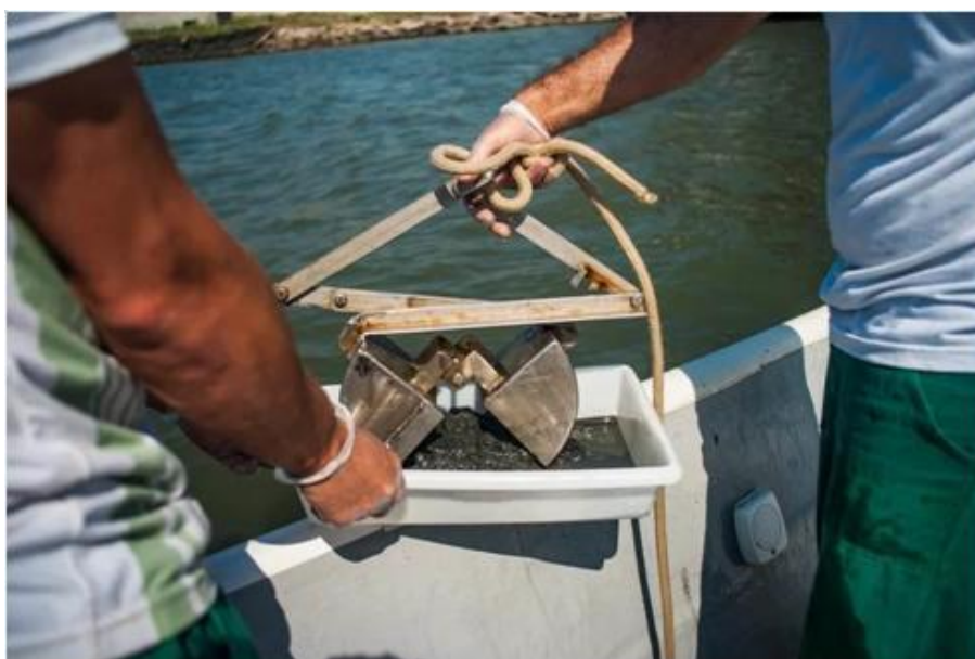
Figura 58. Coleta de amostra de sedimento com draga busca fundo van Veen .
