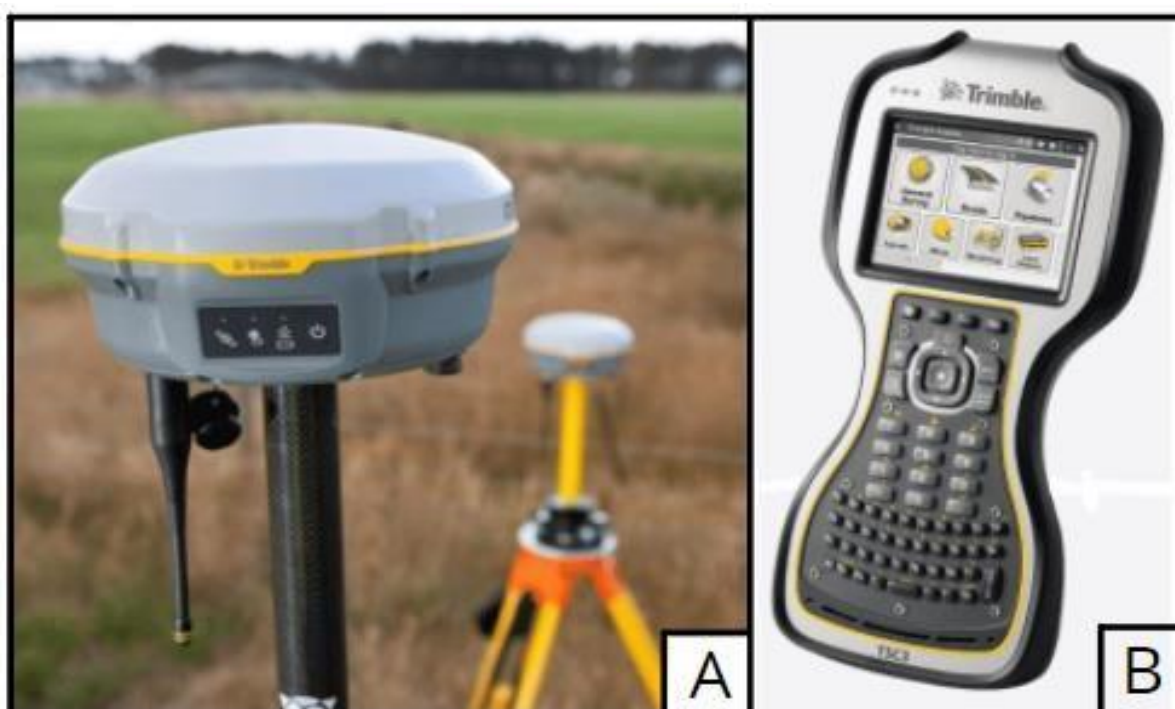
Figura 16. (A) Antena base fixada ao fundo, e antena rover à frente, modelo Trimble R8S.
