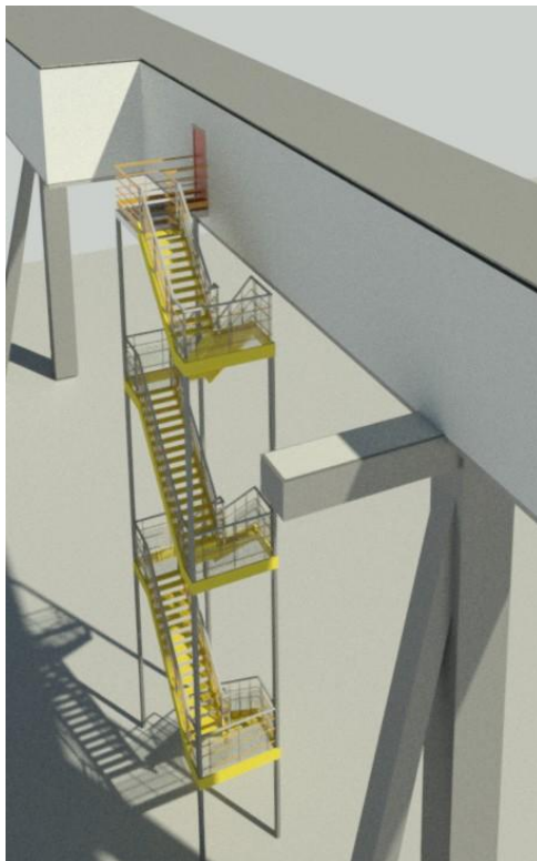
10.1.16. Referência 16 – Desenho referencial para escada de acesso, localizado ao final do corredor de exportação
