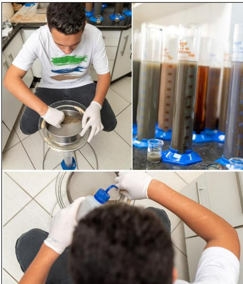
Figura 139. Método de pipetagem, utilizado para determinar o tamanho dos grãos nas frações lamosas.
