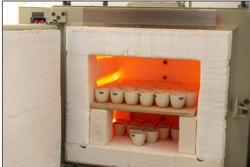
Figura 140. Forno mufla, utilizado para a determinação de matéria orgânica e carbonatos.
