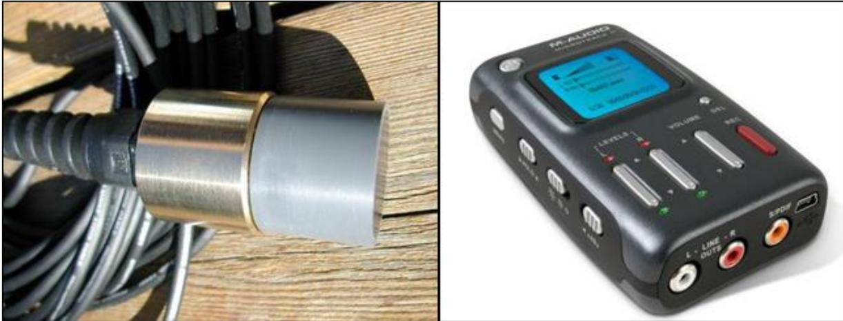
Figura 207. A esquerda o Hidrofone *Cetacean Research SQ26-08*, e a direita o gravador digital *M-Audio Microtrack II*, utilizados para a coleta de dados de acústica na baía da Babitonga (SC).
