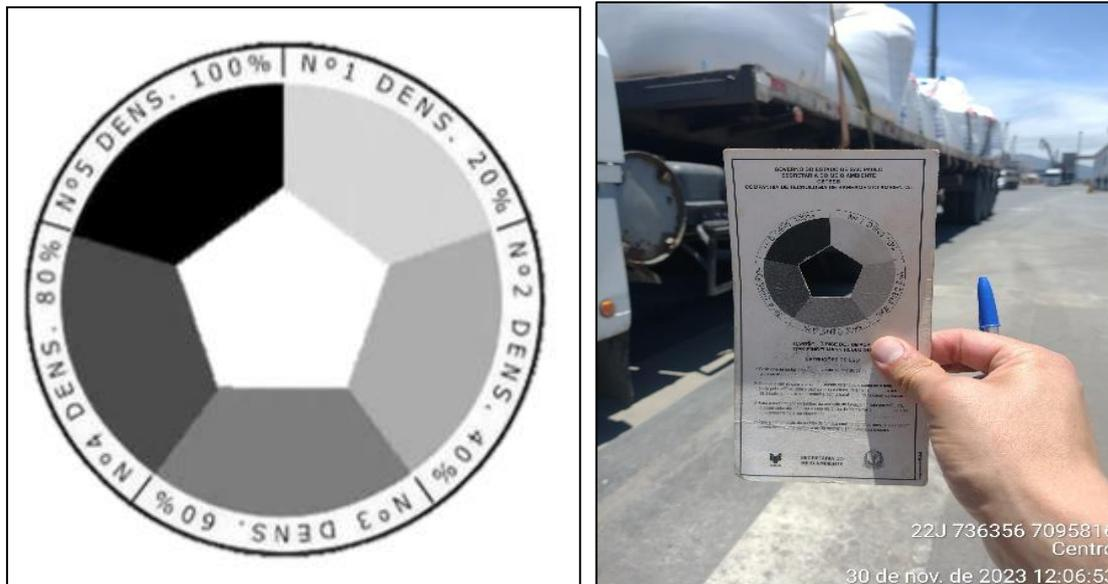
Figura 236. Monitoramento de fontes móveis utilizando a Escala de Ringelmann.
