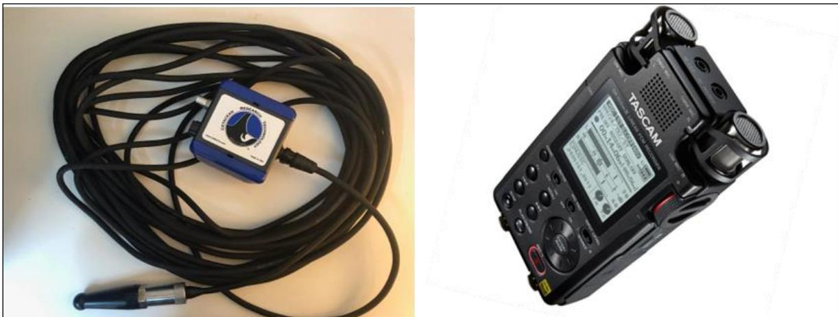
Figura 208. A esquerda o Hidrofone *Cetacean Research Model C75-DR100*, e a direita o gravador digital *TASCAM DR-100 mkIII*, utilizados para a coleta de dados de acústica na baía da Babitonga (SC), a partir de janeiro de 2019.
