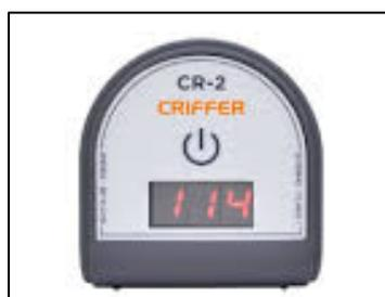
Figura 317. Calibrador de nível sonoro.
