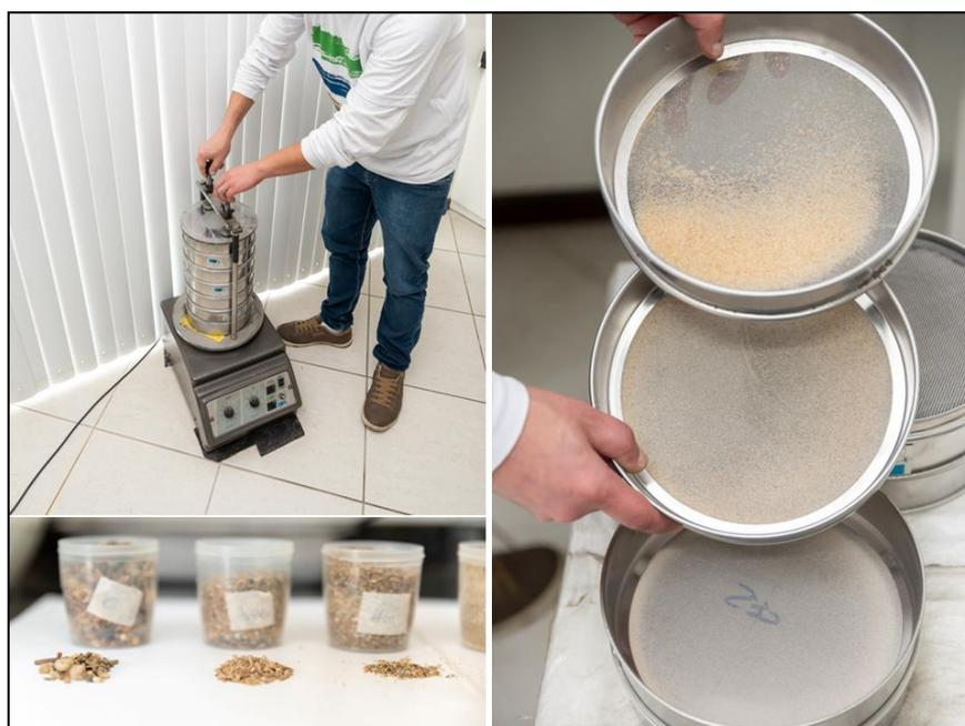
Figura 138. Agitador e peneiras utilizadas para o peneiramento, etapa da análise granulométrica.
