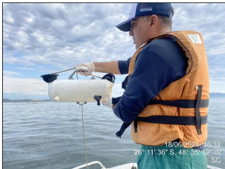
Figura 17. Garrafa amostradora do tipo *van Dorn* utilizada para coleta de água.
