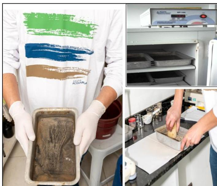
Figura 137. Estufa utilizada para a secagem dos sedimentos.
