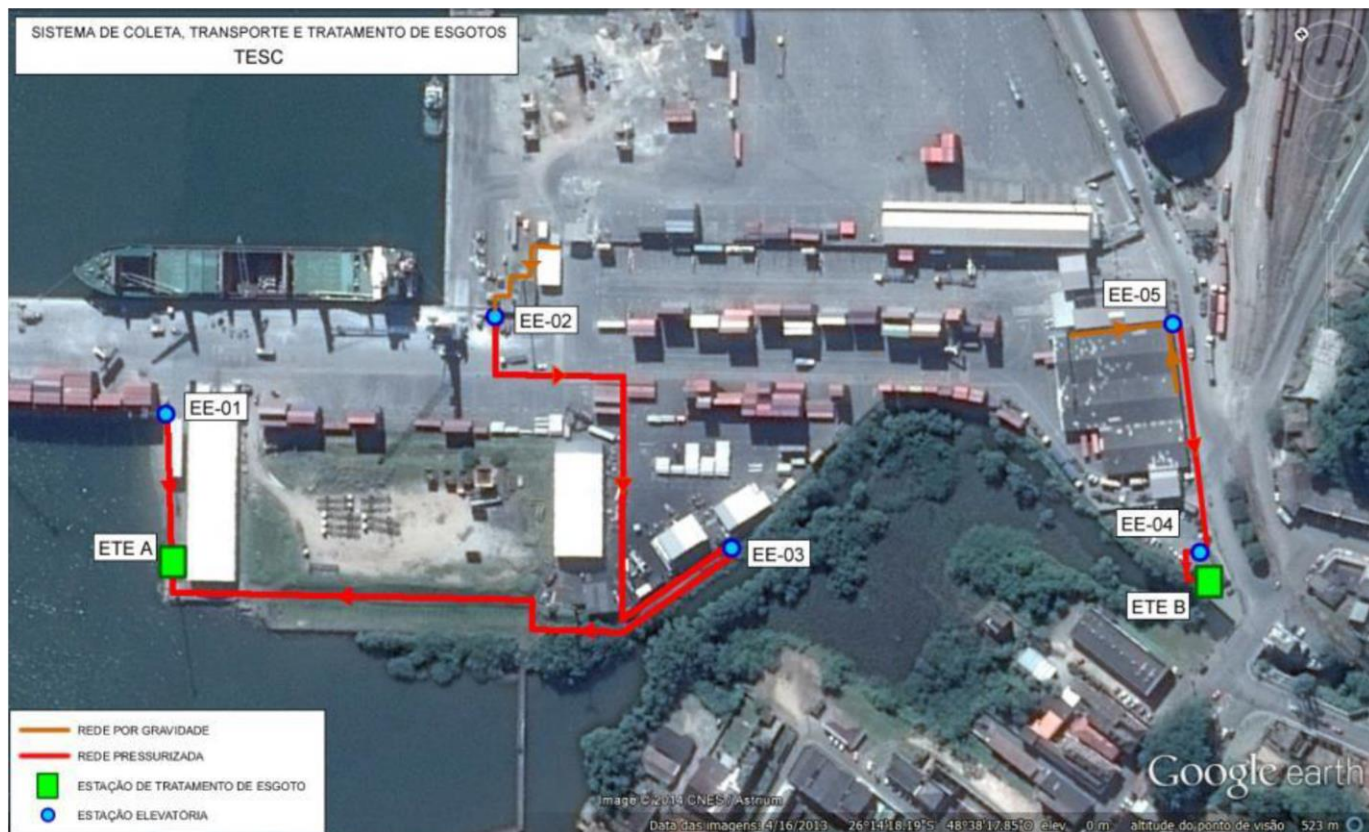
Figura 3: Sistema de tratamento de Efluente Sanitário
