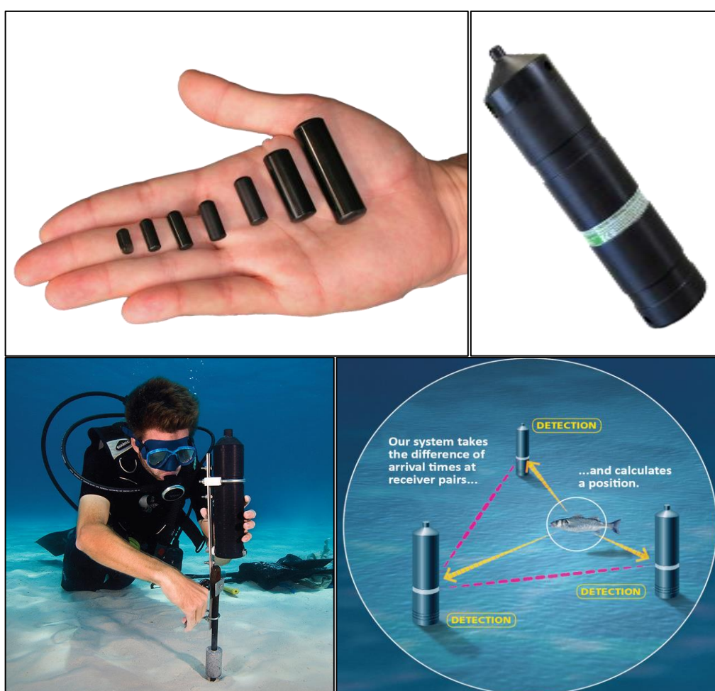
Figura 51. A - Transmissores contínuos de 69 kHz a 180 kHz (superior a esquerda). B - Receptor de monitoramento acústico (superior a direita). C - Instalação de receptores acústicos (inferior a esquerda). D - Esquema do sistema de posicionamento acústico subaquático de alta precisão, capaz de fornecer resolução na escala de metros, monitorando a posição de diversos indivíduos simultaneamente (inferior a direita). Fonte: Lunus Comércio e Representações.
