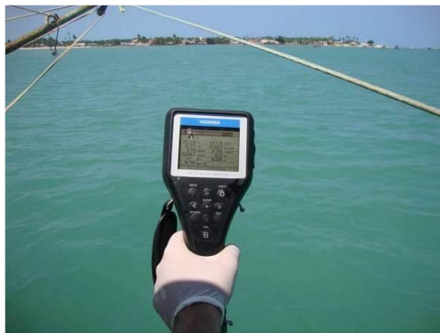
Figura 26. Sonda multiparâmetros para aquisição de dados na área de estudo do sistema aquaviário do complexo portuário de São Francisco do Sul (SC).
