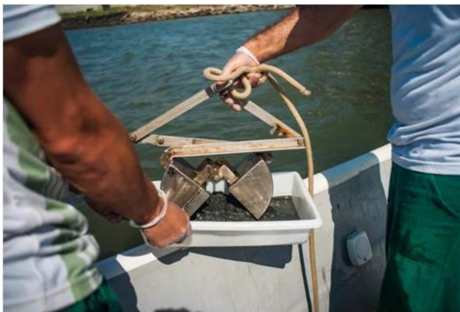
Figura 59. Coleta de amostra de sedimento com draga busca fundo van Veen .
