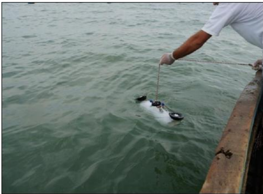
Figura 58. Garrafa van Dorn utilizada para a coleta de amostra de água.
