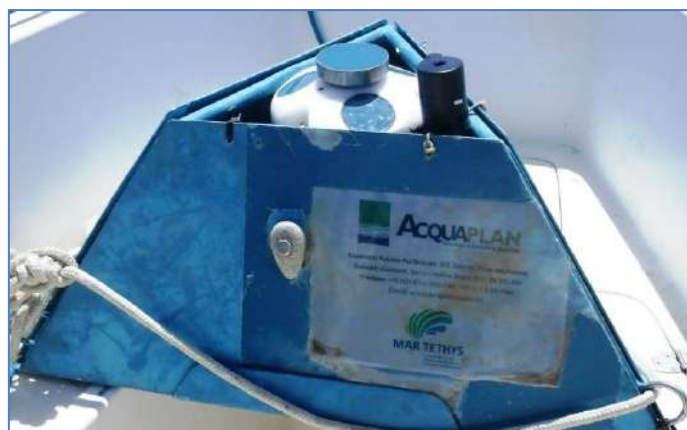
Figura 7. Equipamento AWAC® utilizado no fundeio já fixado em estrutura piramidal.
