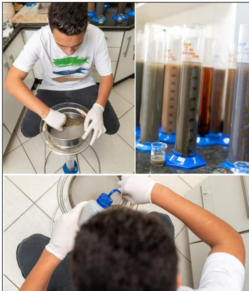
Figura 134. Agitador e peneiras utilizadas para o peneiramento, etapa da análise granulométrica.
