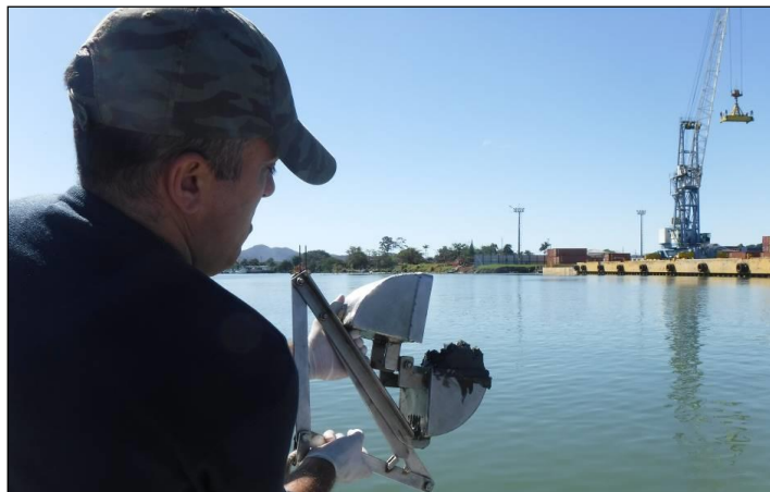
Figura 130. Dragas tipo van Veen utilizada para coleta de sedimentos superficiais.
