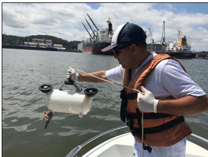
Figura 16. Garrafa amostradora do tipo van Dorn utilizada para coleta de água.
