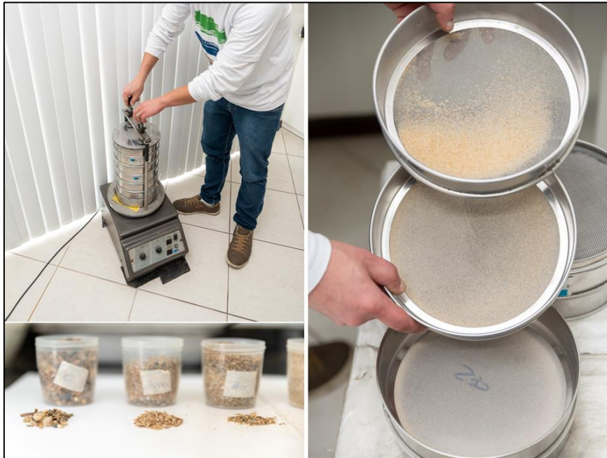
Figura 134. Agitador e peneiras utilizadas para o peneiramento, etapa da análise granulométrica.
