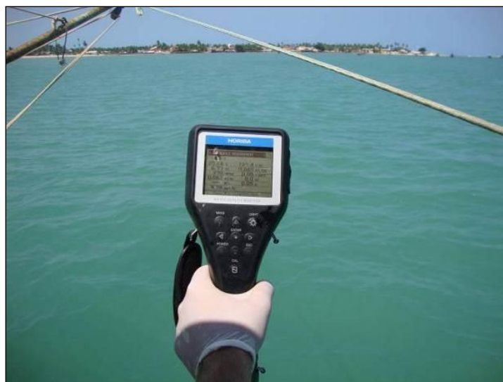
Figura 15. Sonda multiparâmetro para aquisição de dados na área de estudo do sistema aquaviário do Porto de São Francisco do Sul (SC).
