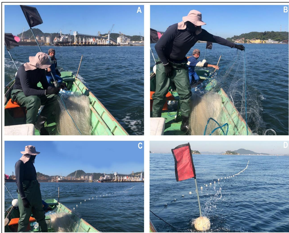
Figura 90. Amostragem de campo com rede de caceio de superfície/meia-água: preparação das redes de caceio e boias de sinalização (A); soltura de rede de caceio ao mar (B e C); boia e rede preparados para obtenção do material biológico (D).
