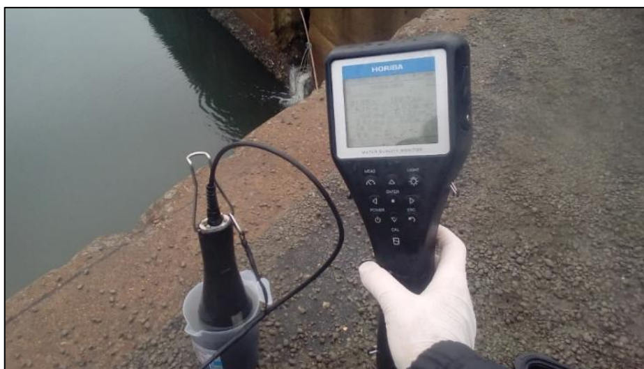
Figura 280. Sonda Horiba utilizada para aferição de parâmetros in situ .
