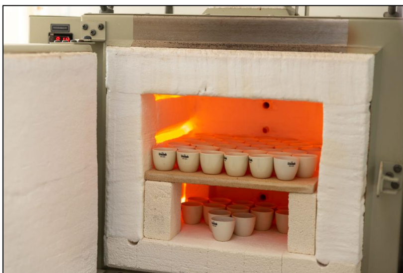
Figura 136. Forno mufla, utilizado para a determinação de matéria orgânica e carbonatos.
