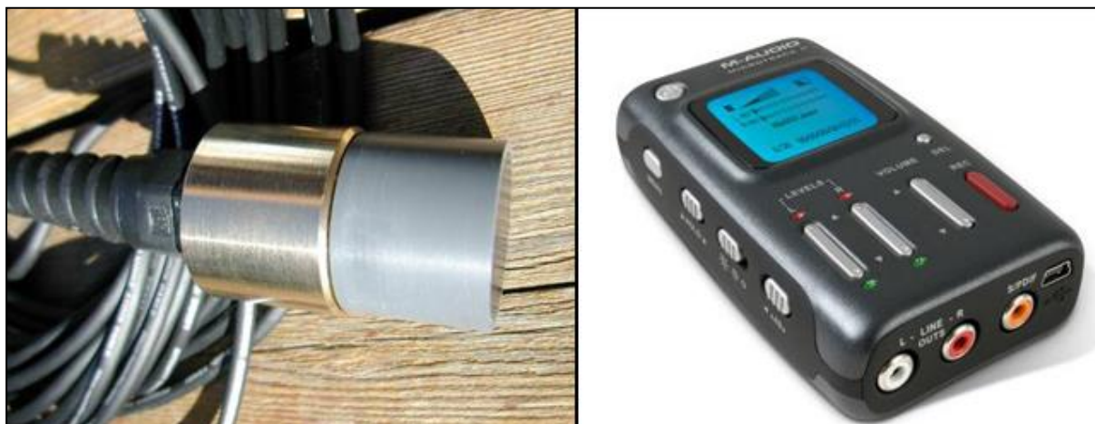
Figura 233. A esquerda o Hidrofone Cetacean Research SQ26-08 , e a direita o gravador digital M-Audio Microtrack II , utilizados para a coleta de dados de acústica na baía da Babitonga (SC).
