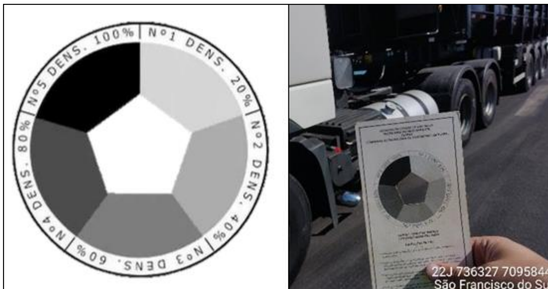
Figura 299. Monitoramento de fontes móveis utilizando a Escala de Ringelmann.
