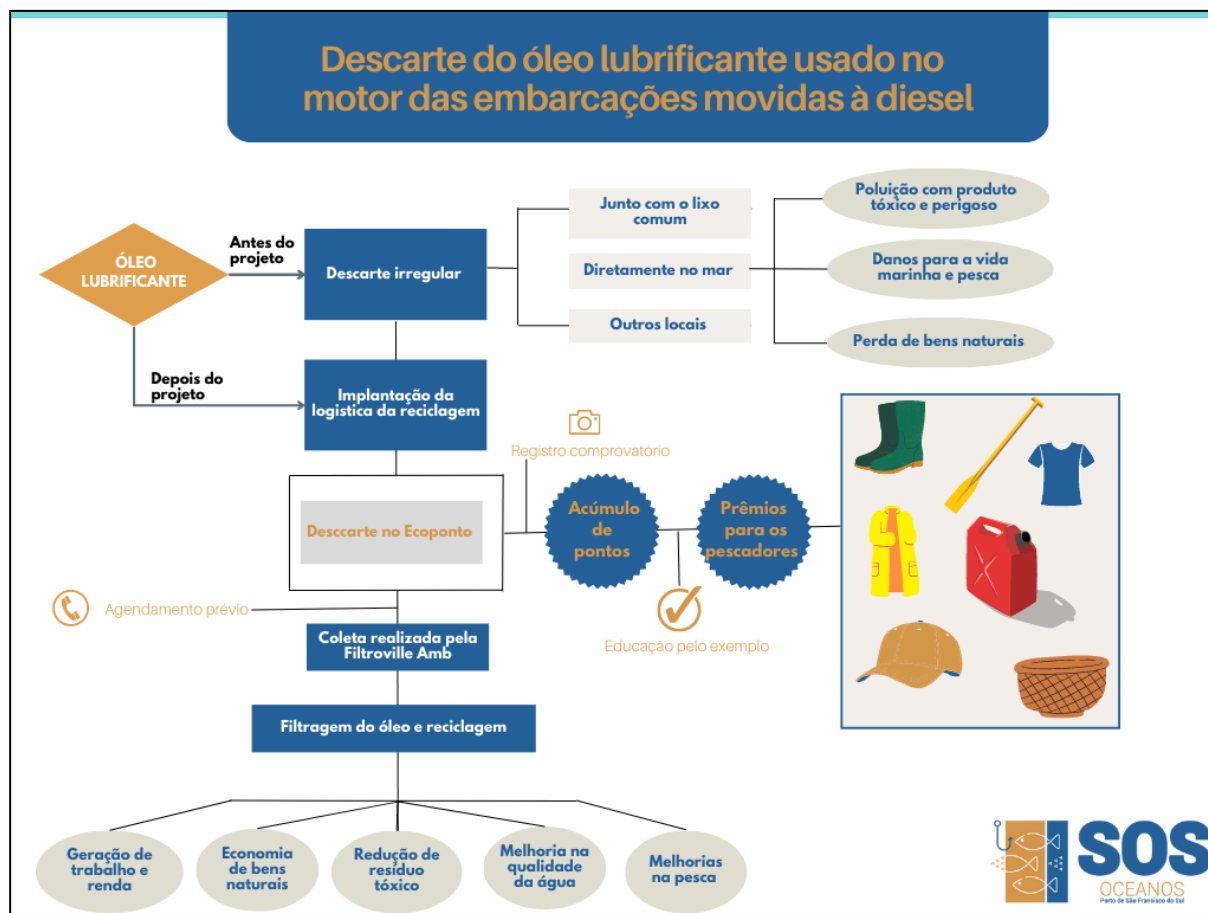
Figura 331. Fluxograma com a rede de atores, estrutura e ações arquitetadas para implantar a logística da reciclagem do óleo lubrificante usado nas embarcações.
