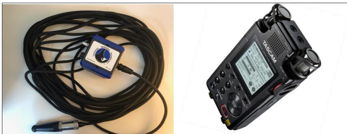
Figura 234. A esquerda o Hidrofone Cetacean Research Model C75-DR100 , e a direita o gravador digital TASCAM DR-100 mkIII , utilizados para a coleta de dados de acústica na enseada da Praia do Porto, Imbituba (SC), a partir de janeiro de 2019.
