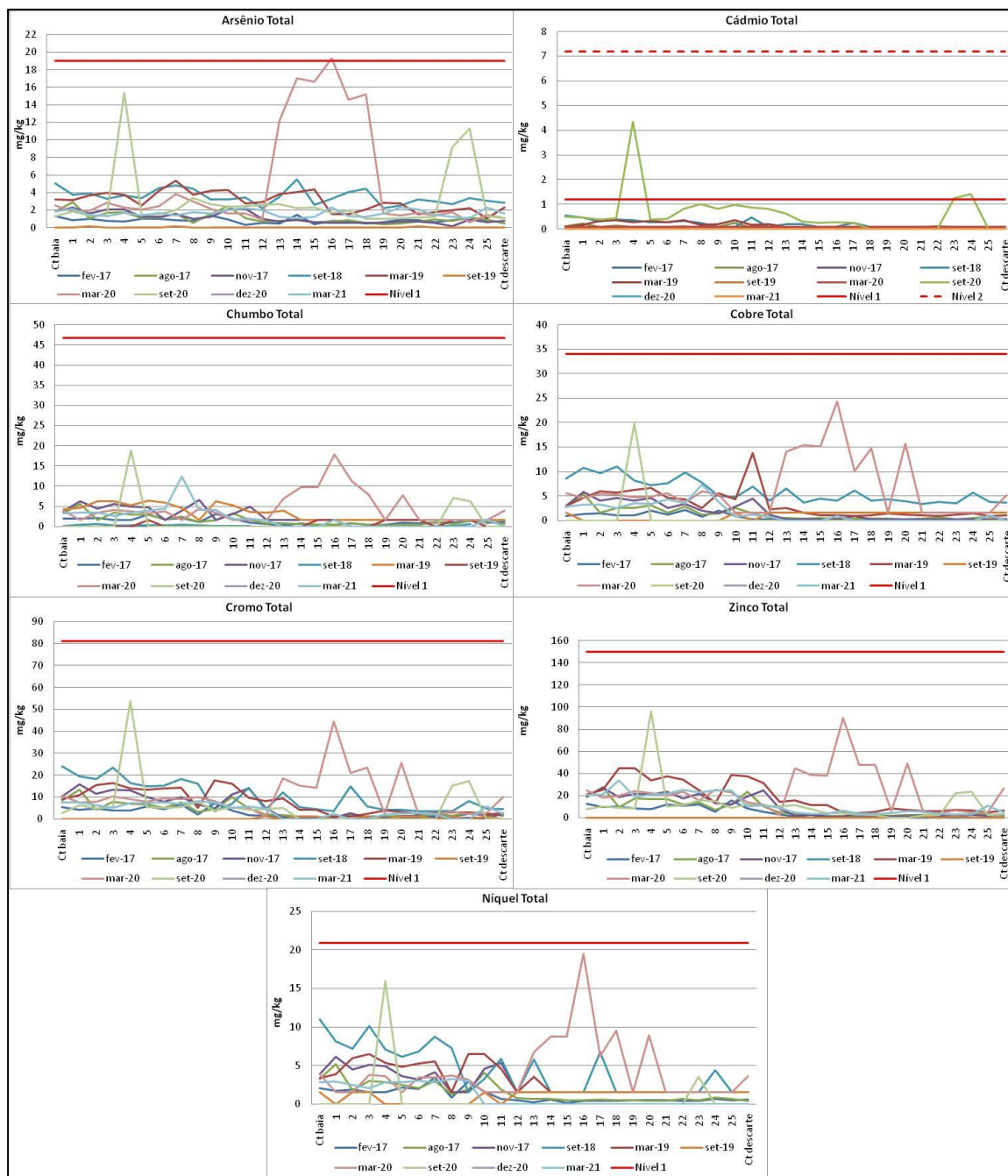
Figura 177. Concentrações de metais em 27 amostras de sedimentos superficiais coletados na área de influência do Porto de São Francisco de Sul em fevereiro, agosto e novembro de 2017, setembro de 2018 e março, setembro de 2019, março, setembro e dezembro de 2020 e março de 2021.
