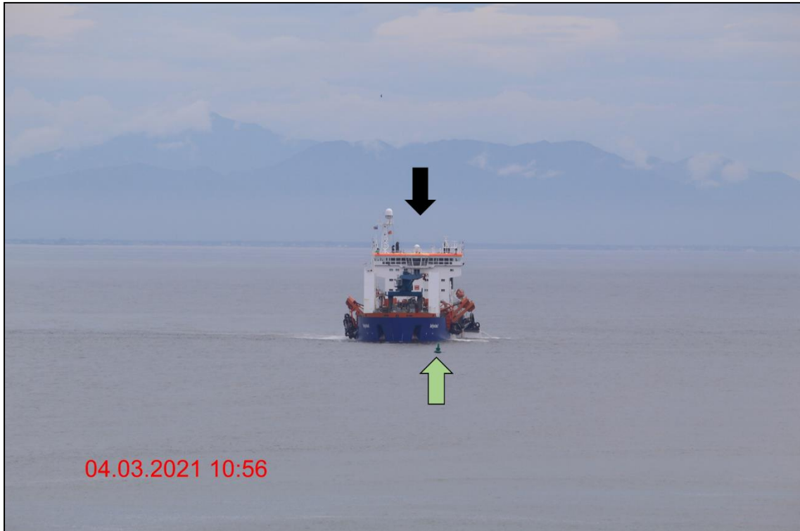
Figura 441: Seta em preto indica a Draga recolhendo os tubos de sucção em posição estável, em verde está a boia de sinalização do canal externo.
