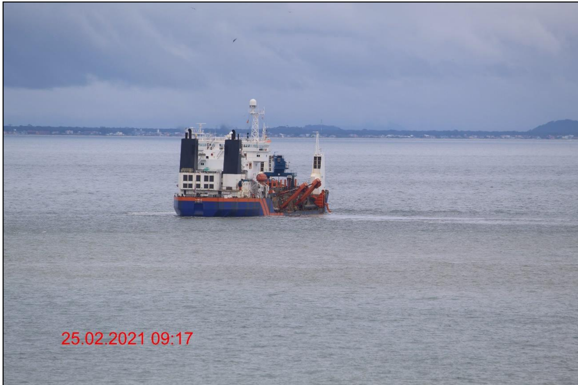
Figura 433: Lelystad com os tubos de sucção submersos realiza a manobra a 180°.
