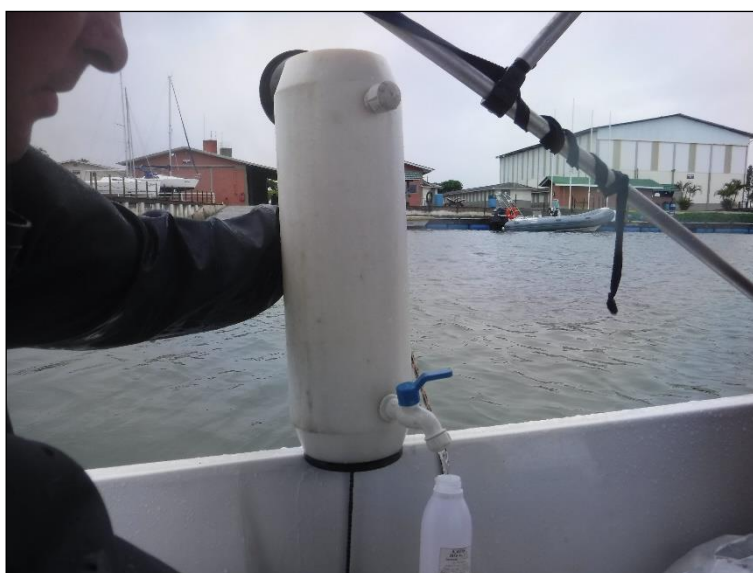
Figura 13. Transferência da amostra de água da garrafa para os frascos de vidro.
