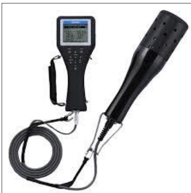
Figura 11. Sonda multiparâmetros Horiba U-50.
