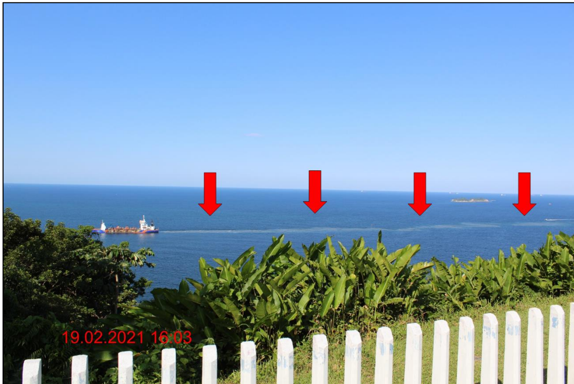
Figura 428: Lelystad carregando a cisterna no canal externo sentido canal interno, em sua esteira observa a formação da pluma de sedimento identificada pelas setas em vermelho.
