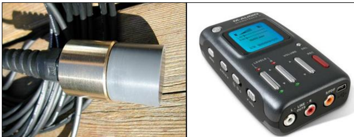
Figura 243. A esquerda o Hidrofone Cetacean Research SQ26-08, e a direita o gravador digital M-Audio Microtrack II, utilizados para a coleta de dados de acústica na baía da Babitonga (SC).
