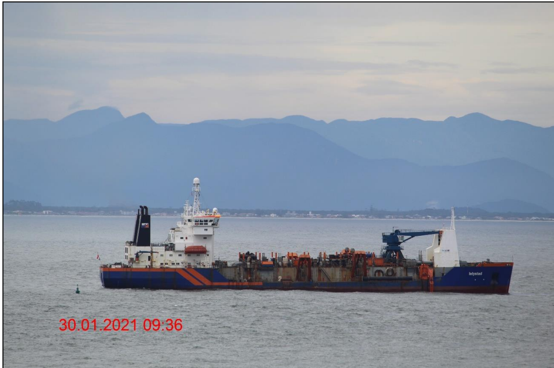
Figura 405: A Draga Lelystad submerge os tubos de sucção disposto em cada lado da embarcação com a cisterna vazia.
