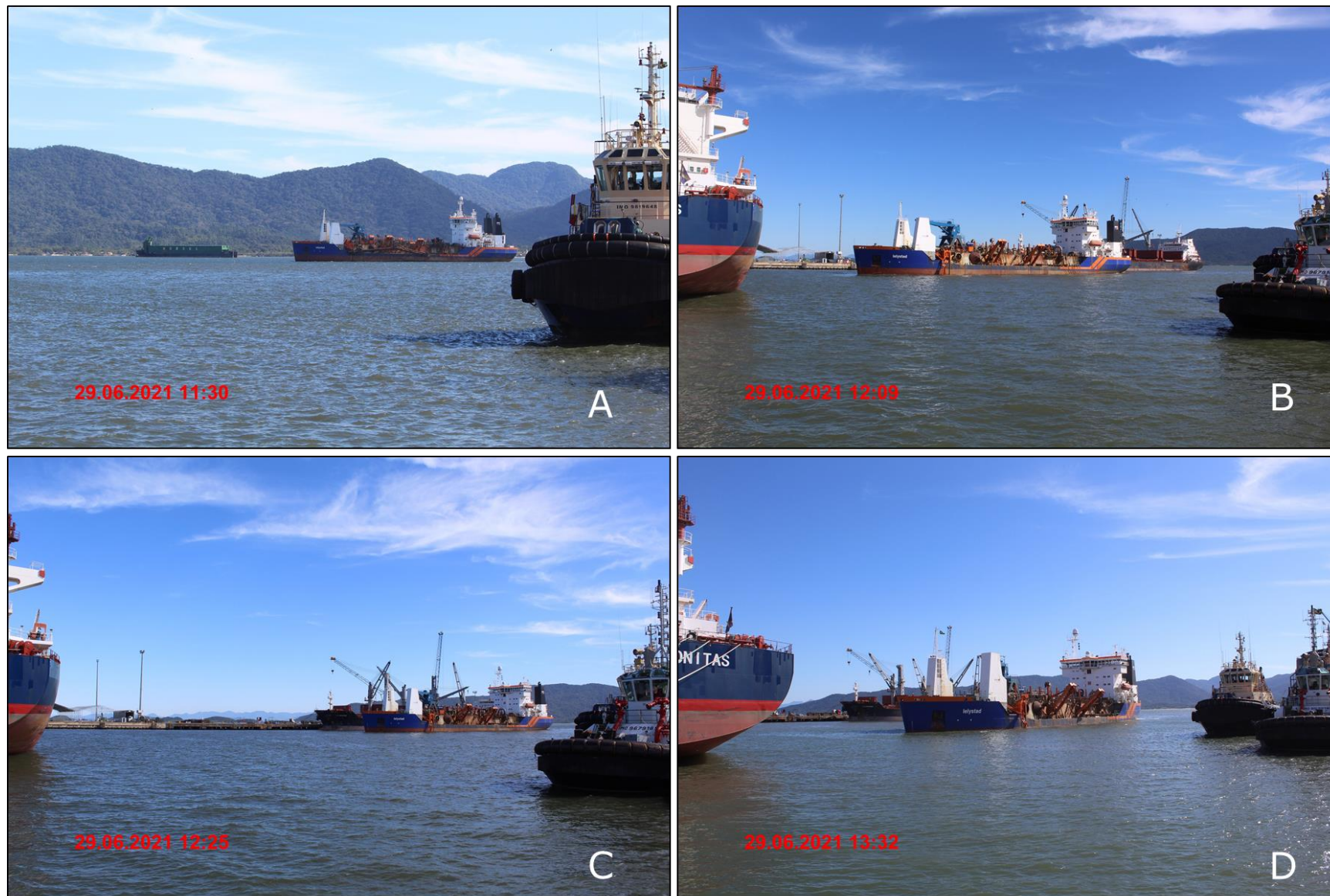
Figura 450: (A) Lelystad submerge os tubos de sucção. (B) Realiza a dragagem em linha. (C) Retorna à ré. (D) Opera na Dársena.
