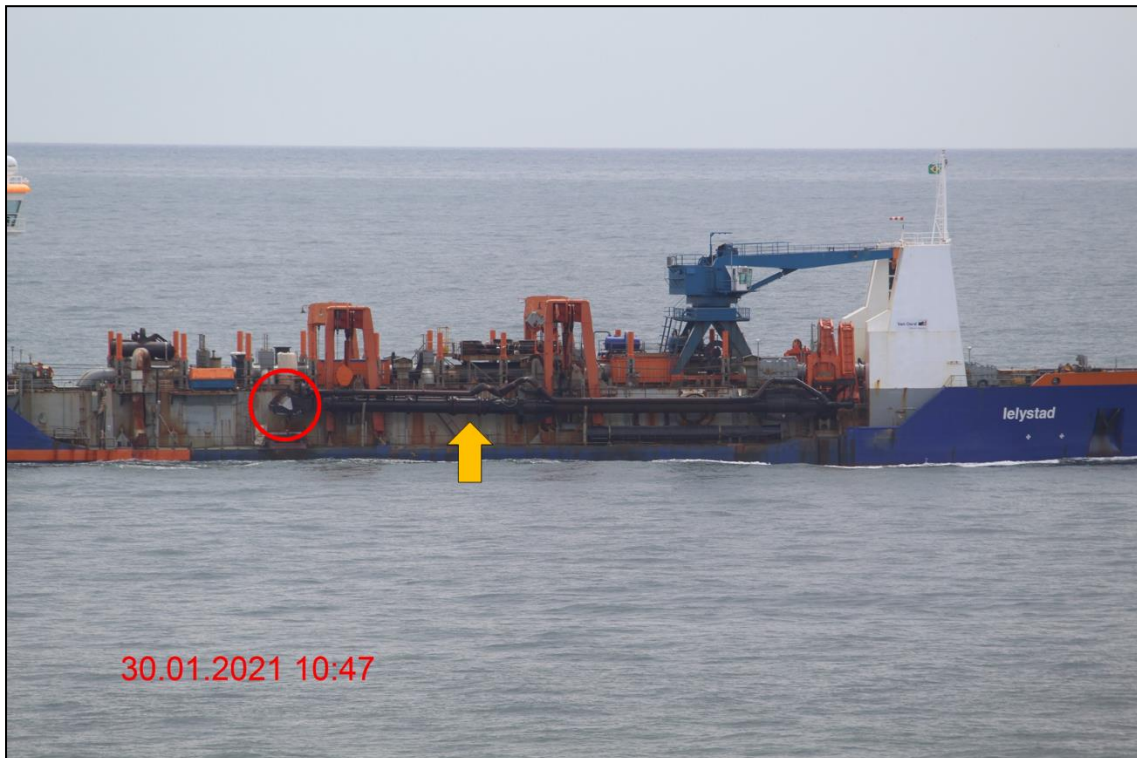
Figura 407: Os tubos de sucção identificados pela seta em laranja, circulado em vermelho está a cabeça de dragagem, ambas dispostas em cada lado da embarcação com a cisterna carregada.
