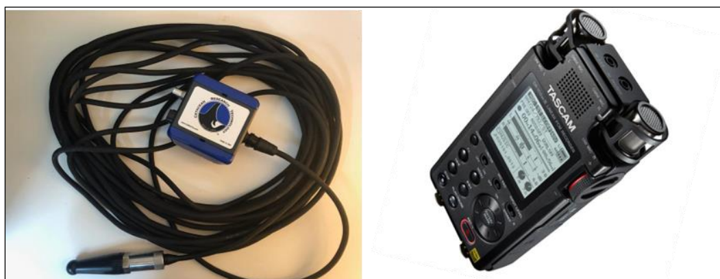
Figura 244. A esquerda o Hidrofone Cetacean Research Model C75-DR100, e a direita o gravador digital TASCAM DR-100 mkIII, utilizados para a coleta de dados de acústica na enseada da Praia do Porto, Imbituba (SC), a partir de janeiro de 2019.
