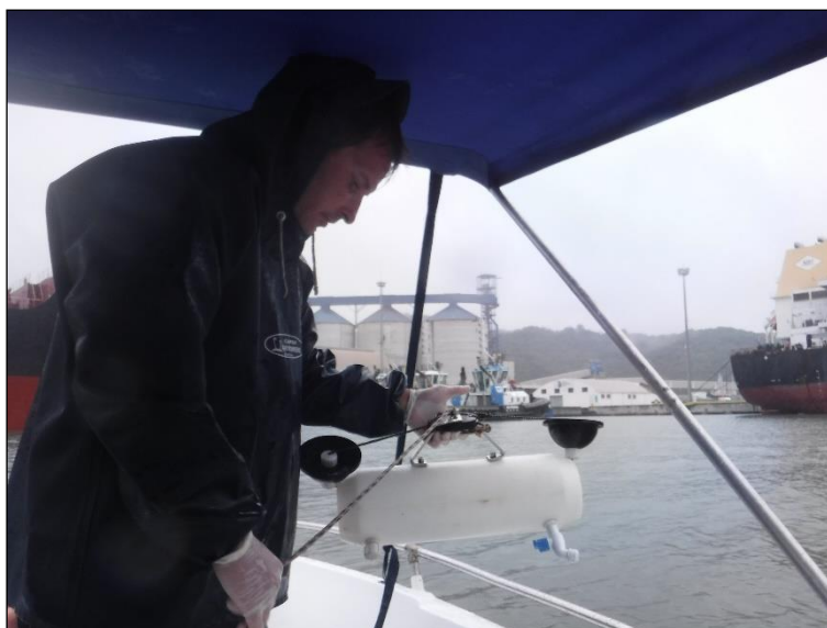
Figura 12. Garrafa amostradora do tipo van Dorn utilizada para coleta de água.
