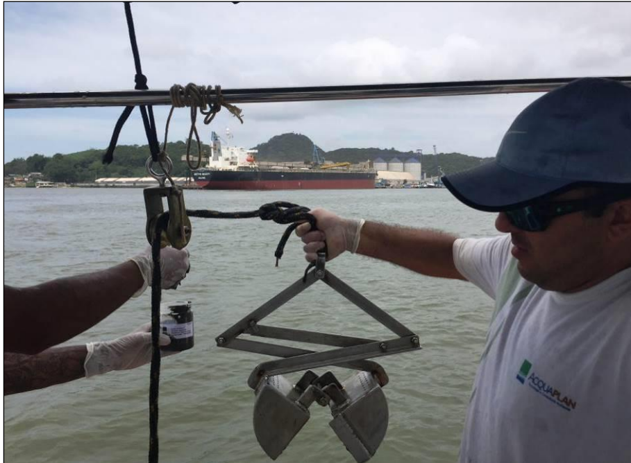
Figura 180. Draga amostradora de sedimento do tipo van Veen .
