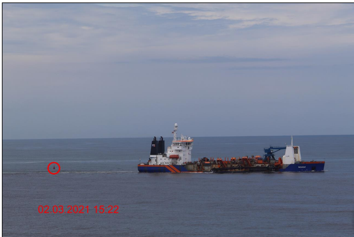
Figura 438: Circulado em vermelho a boia encarnada, a diante está Lelystad com a cisterna carregada recolhem os tubos de sucção, no canal externo.
