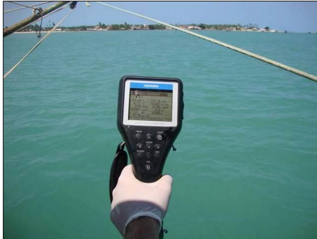
Figura 42. Sonda multiparâmetro para aquisição de dados na área de estudo do sistema aquaviário do Porto de São Francisco do Sul (SC).
