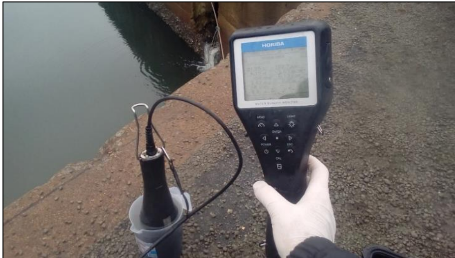
Figura 298. Sonda Horiba utilizada para aferição de parâmetros in situ .
